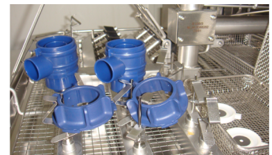
Рисунок 2. Размещение компонентов комплекта клапана выдоха в устройстве
